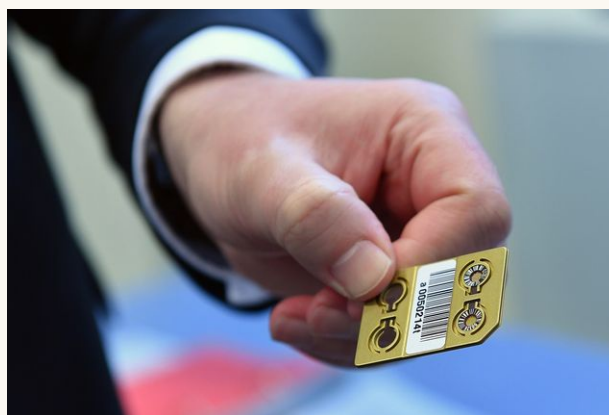
Un dosimètre à thermoluminescence. Le même phénomène qui mesure une dose de radiation mesure, dans un silex, le temps écoulé depuis la dernière chauffe.
